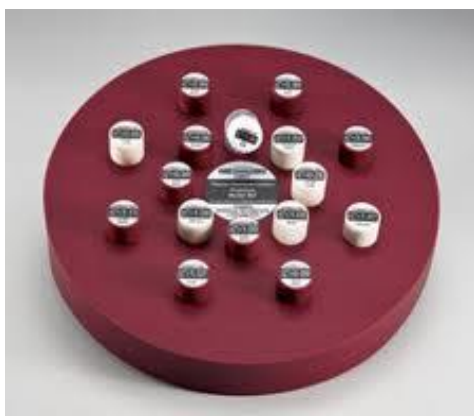
25. ábra: CT linearitás-ellenőrző fantom és a fantomról készült felvétel
