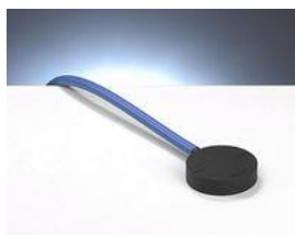
17. ábra: Az abszolút dózis méréséhez szükséges ionizációs kamrák
