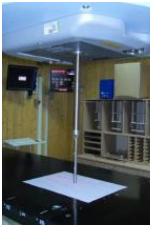
5. ábra: A mechanikai távolságmérő pozicionálása
