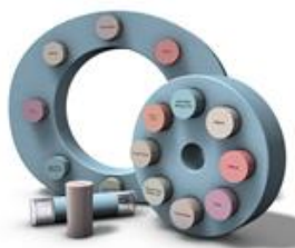
21. ábra: CT sűrűség fantom – 2 különböző átmérővel
