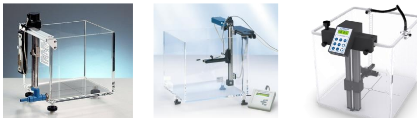
18. ábra: Az abszolút dozimetriához szükséges elektrométerek és 1D vízfantomok.
