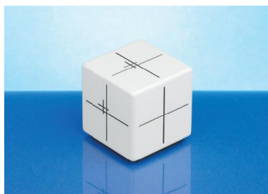
6. ábra: Fali lézerek pozíciókijelzésének ellenőrzéséhez ajánlott kocka
