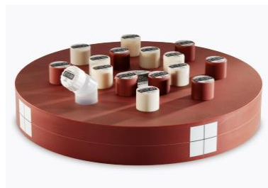
22. ábra: CT sűrűség fantom – egy átmérővel, torzítás mérésre alkalmas jelöléssel
